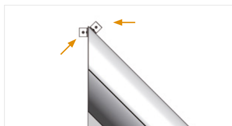
Bei schwerer Zugänglichkeit oder Montage auf die Laibung kommen Zusatzmontagewinkel zum Einsatz.
