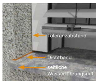
Nicht eingeputzte Führungsschiene mit Steinfensterbank
