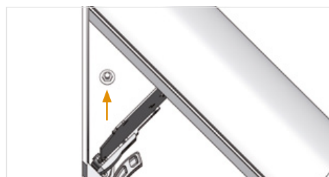
Die Kastenzusatzbefestigung wird soweit oben wie möglich gesetzt.
