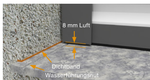
Nicht eingeputzte Führungsschiene mit Steinfensterbank
