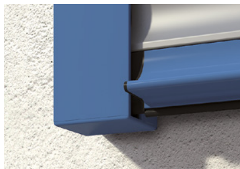
Unterer Verschluss bei Montage auf die Fassade; bei dieser Montageart 10 mm Abstand zur Fassade beachten
