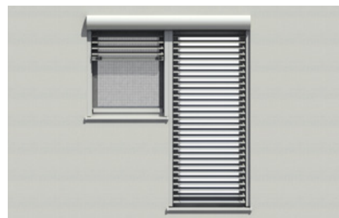
Blendenkombination bei unterschiedlicher Elementhöhe mit zwei Einzelführungsschiene in der Mitte Hinweis: maximale Breite: 6000 mm; INTEGO: maximale Einzelelementbreite 4000 mm
