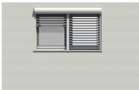
Blenden- und/oder Antriebskombination bei gleicher Elementhöhe mit Doppelführungsschiene in der Mitte Hinweis: maximal 3 Behänge pro Antrieb möglich; maximale Breite: 6000 mm; maximale Fläche: 30 m 2 ; INTEGO: maximale Einzelelementbreite 4000 mm
